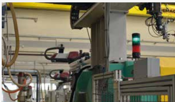
Сигнальная колонна Pfannenbergl BR 50 для обеспечения безопасности машинного оборудования
