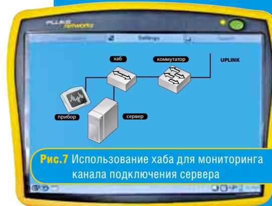
Рис.7 Использование хаба для мониторинга канала подключения сервера
