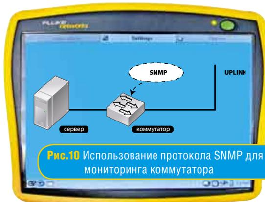
Рис.10 Использование протокола SNMP для мониторинга коммутатора
