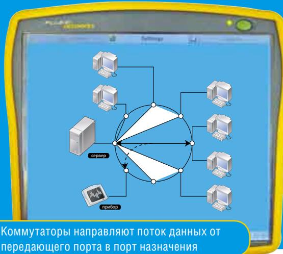
Рис. 5 Коммутаторы направляют поток данных от передающего порта в порт назначения
