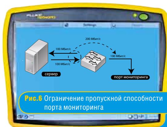
Рис.6 Ограничение пропускной способности порта мониторинга
