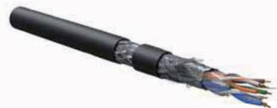
Внешняя оболочка Экран-оплетка Экран-фольга Скрепляющая обмотка Витая пара solid Рипкорд
